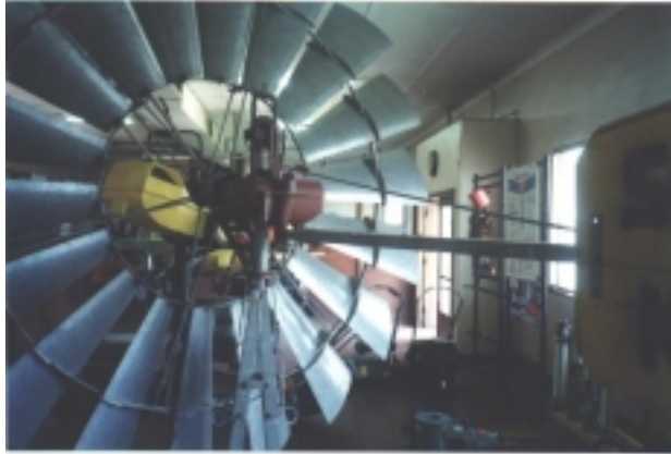
Figura 4 Rotor multipala americano de Alta solidez
