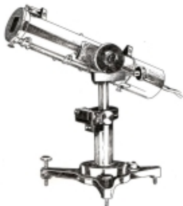
Figura 1. Pirheliómetro de compensación Ångström
